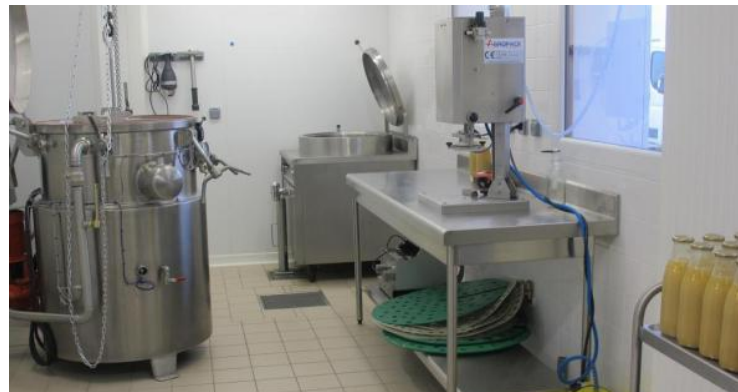
L'autoclave pour stériliser et fabriquer la soupe, la marmite et la capsuleuse – Source site Vieille Eglise
